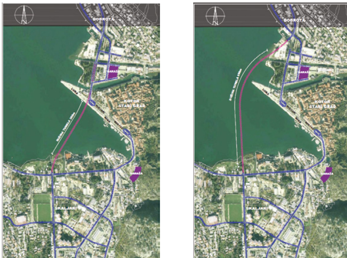
Slika 2: Slika 2. Prijedlog obilaznice oko Kotora – varijante izgradnje podvodnog tunela
